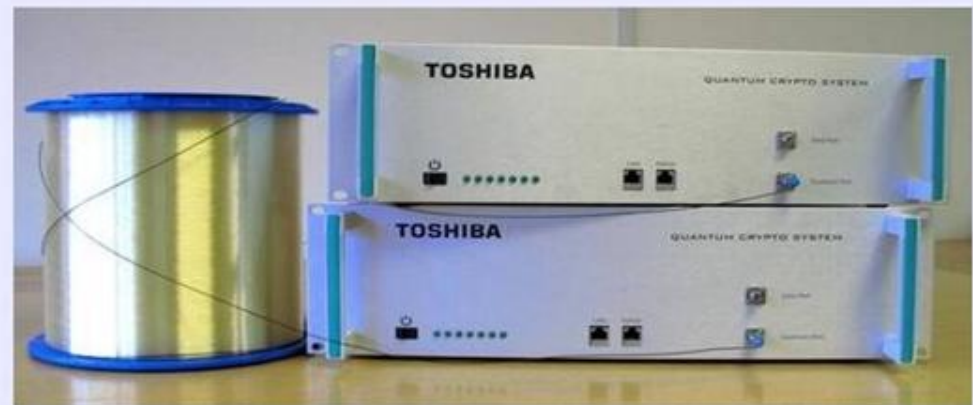
Le système QKD (Quantum Key Distribution) de Toshiba utilisé dans le réseau à Vienne
